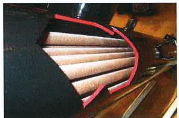
Fig. 1.3. Principe van een watergekoelde condensor (shell and tube uitvoering)
