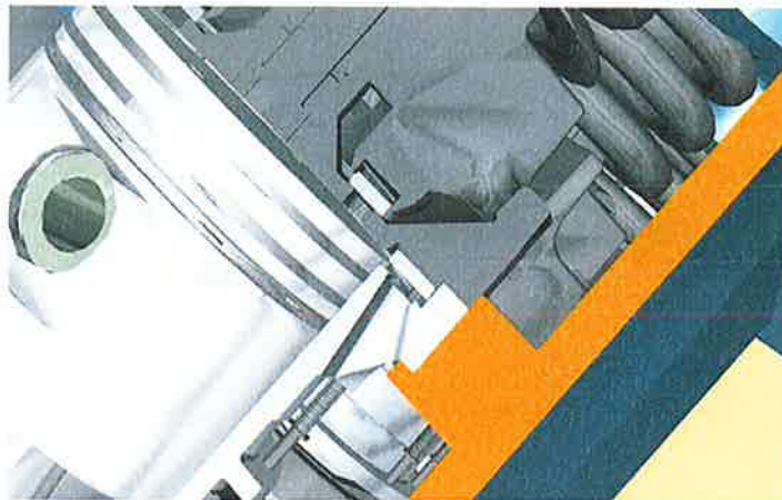
Figuur 4.9 Zuiger, zuigerveren en cilinderpen
